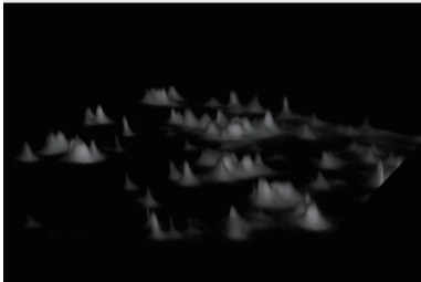
通过的明暗反转增强对比度, 三维显示中亮信号表明 SiC 中位错
